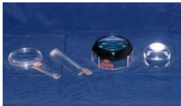
Low Vision Aids comprising + 6.0D Hand Magnifier, 2 x Bar Magnifier, Loupe, 4 x Dome Magnifier
